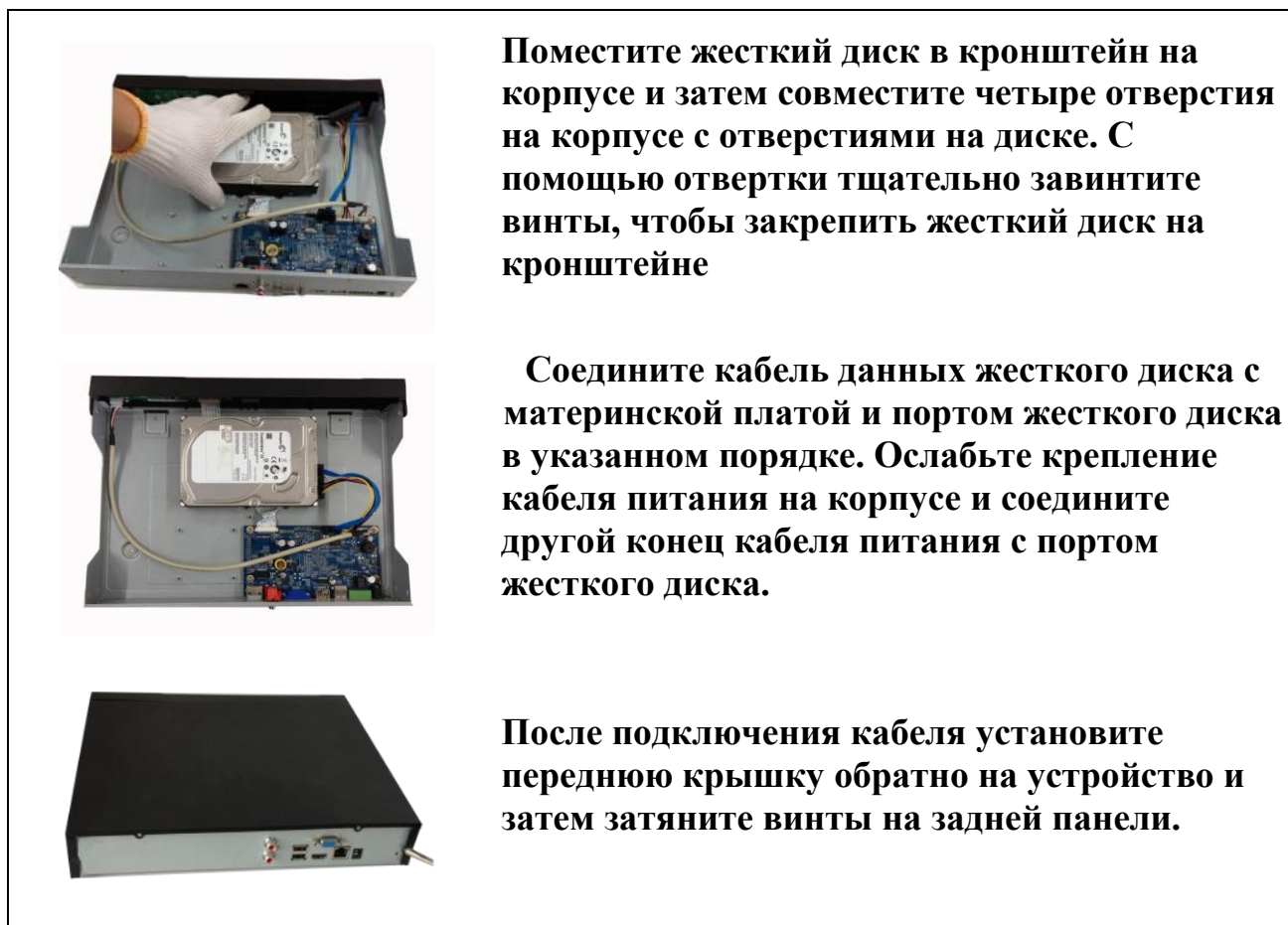
Рисунок 5.1 Установка жесткого диска
