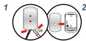
При отключенном электропитании снять крышку корпуса РПУ.
